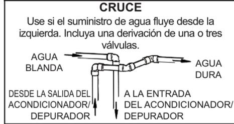
**INSTALACIÓN CON DERIVACIÓN DE TRES VÁLVULAS**
