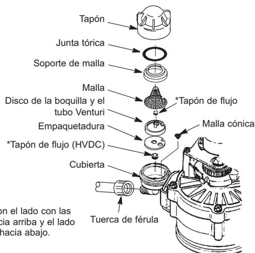
\*Instale con el lado con las letras hacia arriba y el lado cóncavo hacia abajo.
