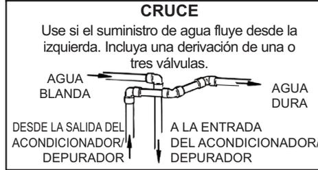
**INSTALACIÓN CON DERIVACIÓN DE TRES VÁLVULAS**
