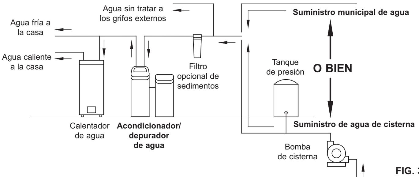
**INSTALACIÓN CON VÁLVULA DE DERIVACIÓN ECOWATER**
