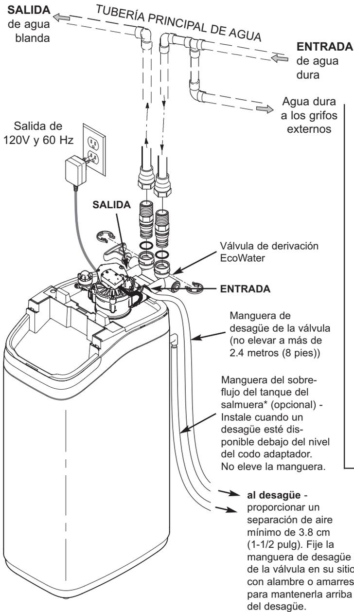
\*No conecte la manguera de desagüe de la válvula del acondicionador/depurador de agua a la manguera de rebose del tanque de salmuera.
