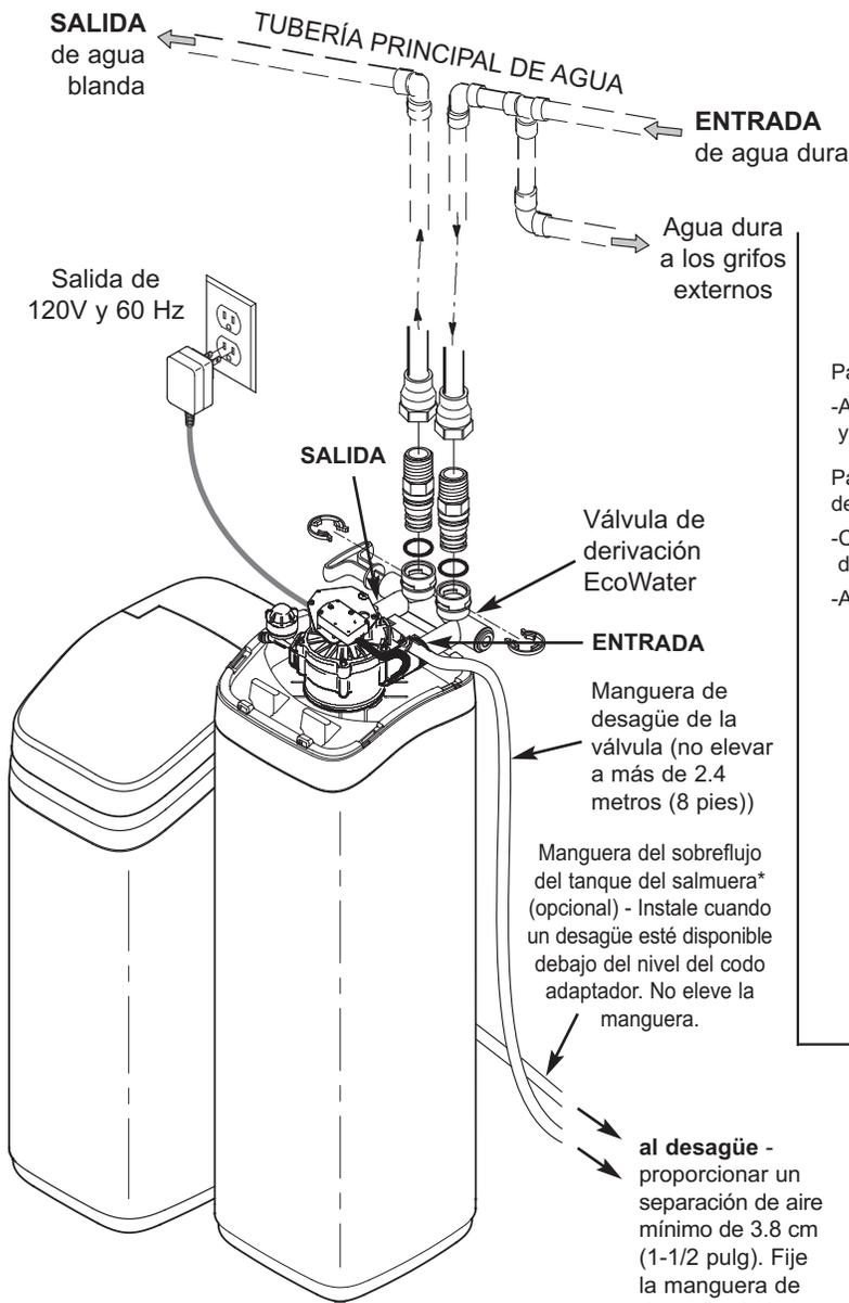
\*No conecte la manguera de desagüe de la válvula del acondicionador/depurador de agua a la manguera de rebose del tanque de salmuera.
