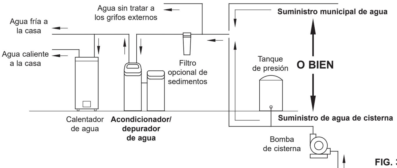
**INSTALACIÓN CON VÁLVULA DE DERIVACIÓN ECOWATER**
