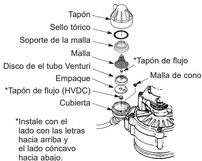
**IMPORTANTE:** Asegúrese de que el orificio pequeño de la empaquetadura se centre directamente sobre el orificio pequeño de la cubierta de la boquilla y del tubo Venturi. Asegúrese de que los números estén mirando hacia arriba.
