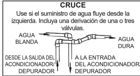
**INSTALACIÓN CON DERIVACIÓN DE TRES VÁLVULAS**
