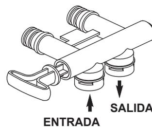
Si la conecta a la plomería a nivel del piso, gire la válvula de derivación hacia abajo
