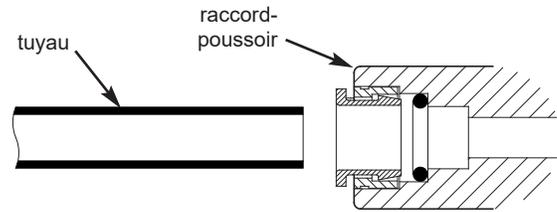
Couper le tuyau à angle droit; les extrémités doivent être rondes, lisses, sans entailles, encoches ni méplats.
