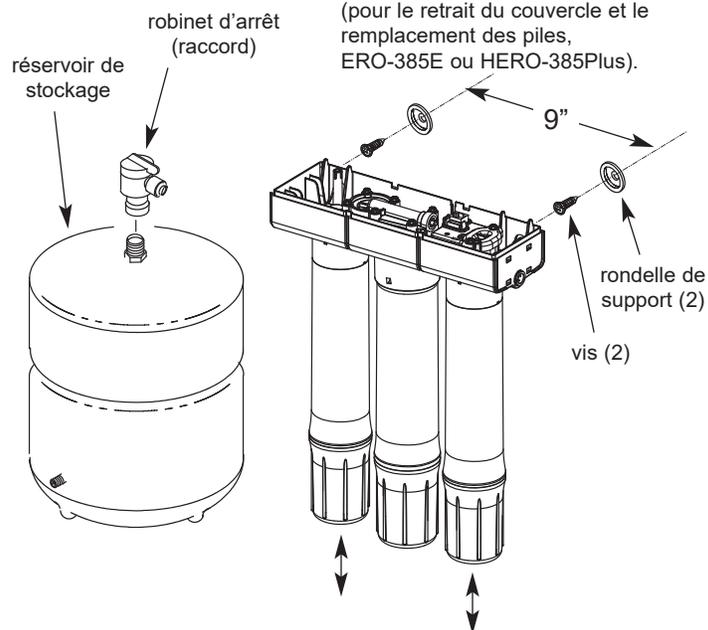
**REMARQUE :** Prévoir un dégagement supérieur de 4 po (10 cm) minimum (pour le retrait du couvercle et le remplacement des piles, ERO-385E ou HERO-385Plus).
