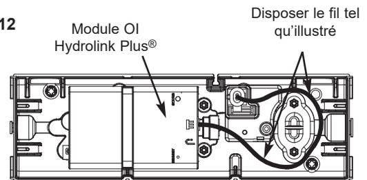
Si le signal Wi-Fi (puissance affichée dans le rapport EASE) est faible, il faudra peut-être monter le module sur la cloison, hors du couvercle OI (cf. Figure 13). Une gorge à l'arrière du module permet de l'accrocher à la verticale à une pièce de fixation (non incluse).
