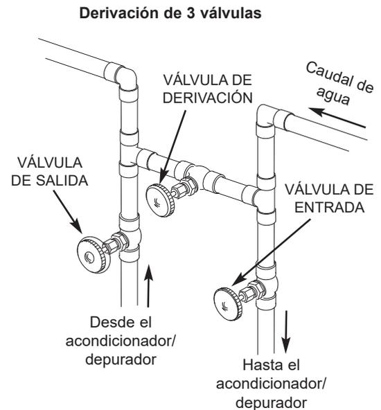
Para **servicio** cierre la válvula de derivación. Abra las válvulas de entrada y salida.
